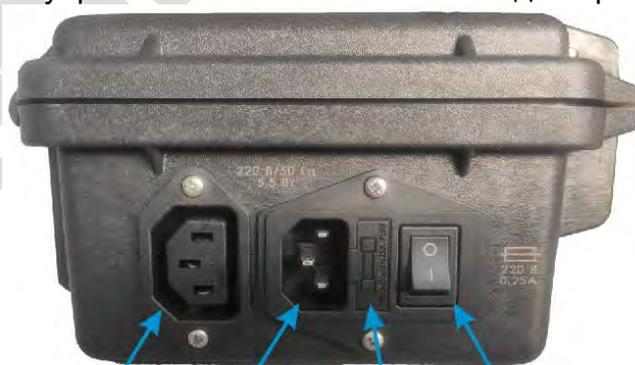
Выход на силовой модуль    Вход 220 В    Предохранитель    Выключатель
